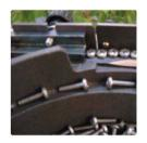
Il gruppo di prelievo è stato studiato per facilitare la cattura della testa della vite e per evitare qualsiasi errore di presa.
